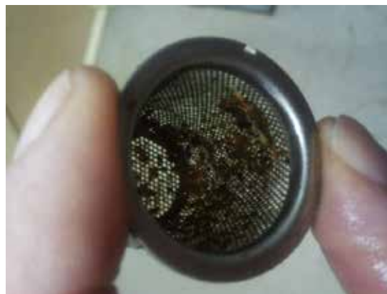
Figur 62. Vänster: Filter (ofta undanskymda), Höger: Ett filter med föroreningar.
