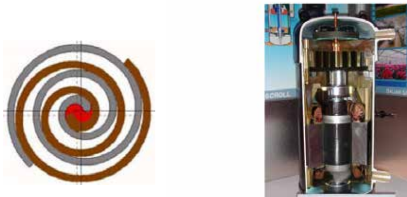
Figur 9. I en Scrollkompressor sker kompressionen av gasen i de utrymmen som bildas mellan två spiralformade kammar. Bilden till vänster visar ett läge där gas har stängts in i de två yttersta månskårsformade utrymmena. Den grå spiralen är fast medan den bruna beskriver en oscillerande rörelse. Vid rörelsen minskar storleken av volymerna mellan spiralerna och den inneslutna gasen förs allt närmare mot mitten. I mitten finns en förbindelse till utloppet. Bilden till höger visar en uppskuren hermetisk scrollkompressor med vertikal axel. I den övre delen kan man se spiralerna i ett snitt från sidan och i den undre delen av figuren syns elmotorn.
