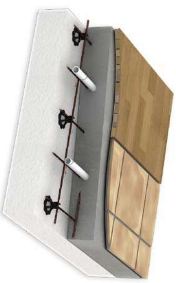
Uponor Golvvärme på armeringsnät ingjutet i betong.
