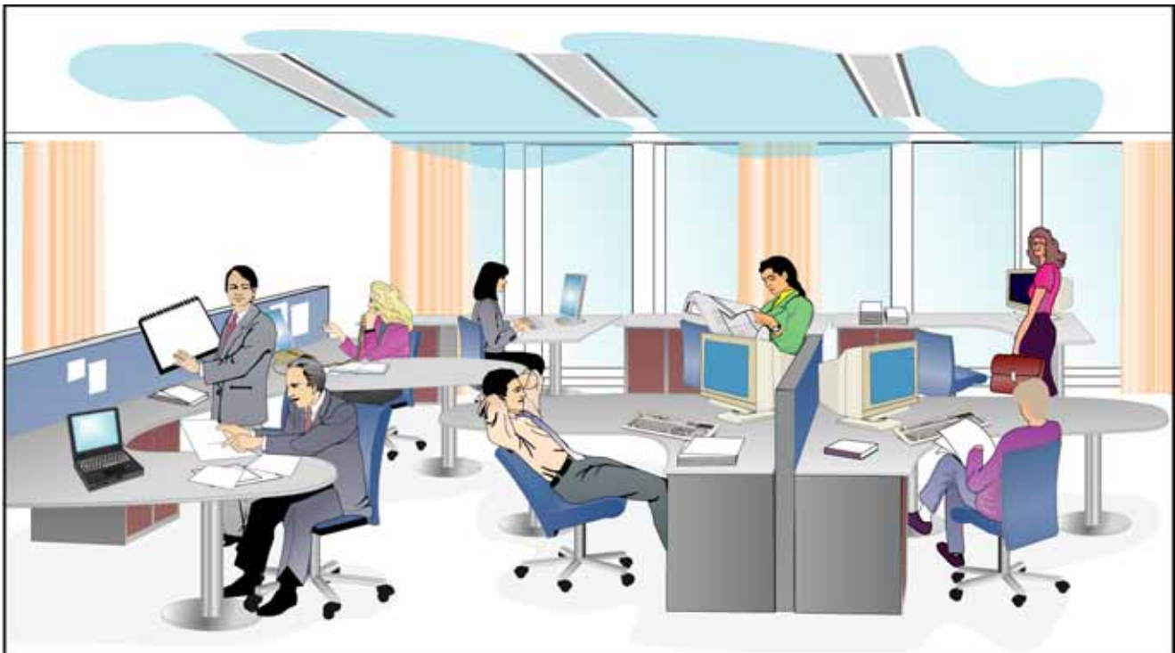
Figur 39. Placering av klimatbafflar i storrum.
