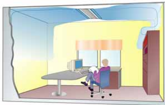
Figur 36. Korridor-fasadororienterad klimatbaffel i cellkontor.
