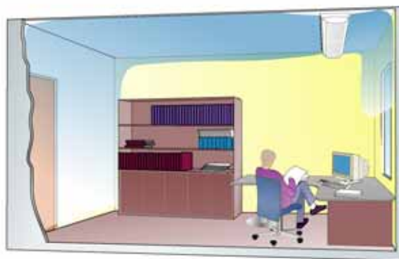
Figur 38. Framkantsplacerad klimatbaffel i cellkontor.
