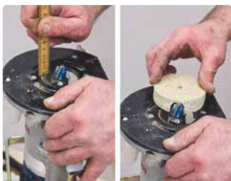
15. Se till att frässtålet inte kan gå djupare än 20 mm.
