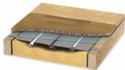
Bild 4: Golvvärmekassett utan isolering
