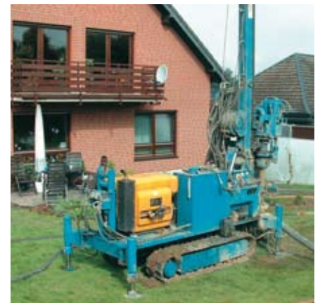
Boring av vertikale borehull
