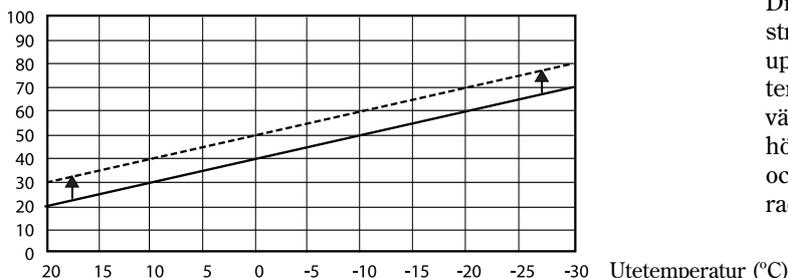
Diagrammet för finjustering visar hur den streckade linjen har parallellförskjutits uppåt. Det betyder att värmen har finjusterats åt plushållet i menyfönstret och att värmepumpen har reglerats för att hålla en högre temperatur på returledningen vilket också ger en högre temperatur på vattnet till radiatorerna.
